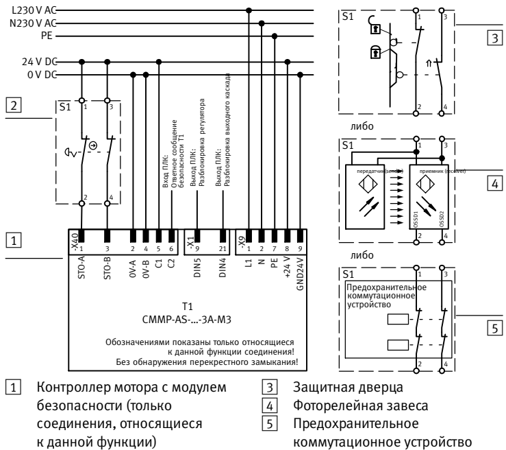
Fig. 4 Подсоединение модуля безопасности CAMC-G-S1, на примере однофазного контроллера мотора CMMP-AS-...-3A-M3
