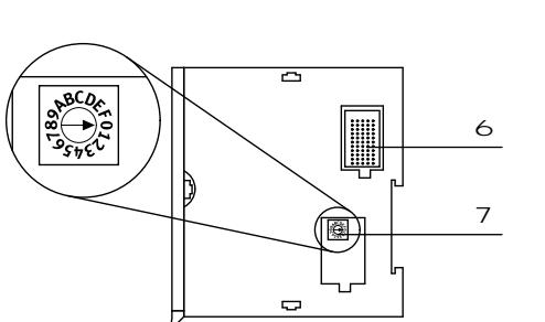
Conector bus, selector de direcciones bajo la tapa
