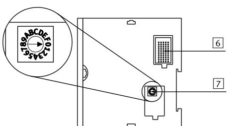
Conector bus, selector de direcciones bajo la tapa
