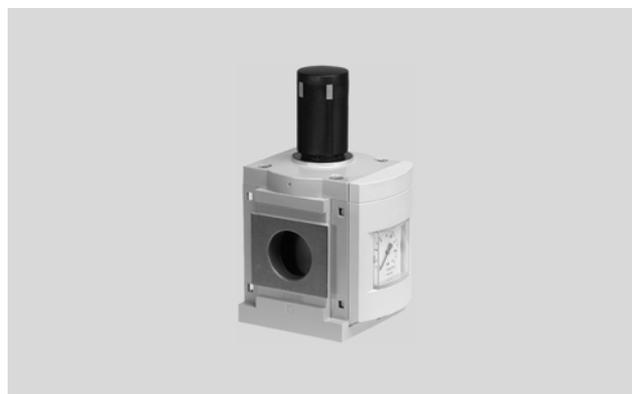
Регулятор давления поддерживает давление на выходе p2 практически постоянным независимо от колебаний давления на входе и расхода потребления. Давление на выходе p2 может быть настроено в пределах регулировки в ручную с помощью поворотной рукоятки, пневматически с помощью задающего сигнала p12,
