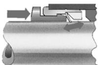
Цанга из нержавеющей стали надежно удерживает шланг, не повреждая его поверхности. Вибрации и скачки давления полностью гасятся.
