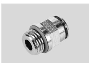
Все металлические цанговые штуцеры изготовлены из никелированной латуни. Высокая стойкость к коррозии и химикатам (CRC3). Для применений пневматики в условиях рабочей температуры до 150 °C и давления до 20 бар.
