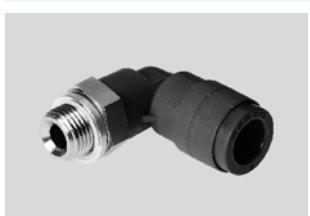
Стойкие к пламени цанговые штуцеры для использования в местах, где присутствует риск появления пламени и искр, например, в системах сварки в автомобильной промышленности и строительстве. Для применений пневматики в условиях рабочей температуры до 60 °C и давления до 10 бар.
