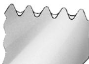
Все латунные части штуцеров Festo никелированы и, таким образом, имеют высокую стойкость к коррозии. Коническая резьба R по ISO имеет самоуплотняющее напыление из PTFE, которое позволяет вкручивать и выкручивать штуцер до пяти раз без использования дополнительного уплотнения.
