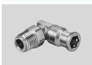
Цанговые штуцеры из нержавеющей стали. Высокая стойкость к коррозии (CRC4) и химическая стойкость, одобрены для использования в пищевой и упаковочной промышленности. Для применений пневматики в условиях рабочей температуры до 120 °C и давления до 10 бар.
