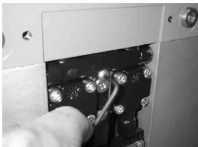
6. Снова вставить в верхний блок распределителей и затянуть крепежный винт сопла.
