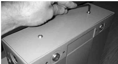
7. Снова установить крышку с помощью двух крепежных винтов (момент затяжки макс. 1 Н·м).
