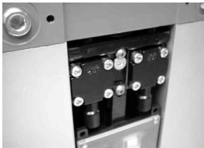
1. Снять переднюю и заднюю (только для PDAD-100) крышку осушителя, см. главе 8.4. Сопло продувки находится в верхнем блоке распределителей.
