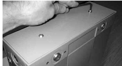
2. Выкрутить оба крепежных винта (PZ 2) крышки и снять крышку.
