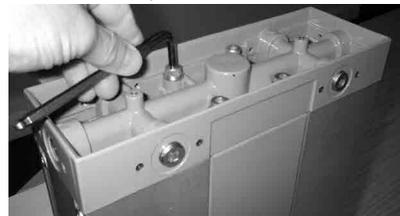
6. Повернуть многоотводный коллектор на 180° и снова смонтировать, пользуясь четырьмя крепежными винтами (момент затяжки макс. 20 Н·м). Проследить за правильной посадкой обоих уплотнительных колец в блоке распределителей.
