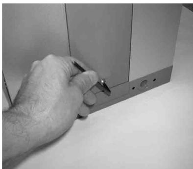
6. Снова установить крепежный винт (момент затяжки макс. 1 Н·м).
