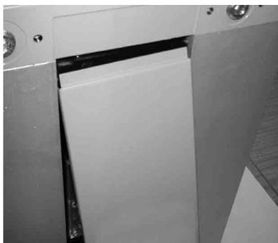
5. Установить крышку, для этого поместить вставную пружину на крышке в паз осушителя. После этого сдвинуть крышку вверх и прижать движением внутрь.
