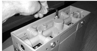
4. Выкрутить четыре крепежных винта многоотводного коллектора (SW 5) и снять коллектор.
