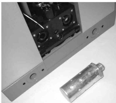
5. Глушитель можно тщательно вымыть теплой водой с мылом. Не пользоваться острыми вспомогательными средствами или инструментами.
