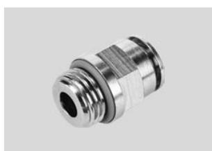
Полностью металлические цанговые штуцеры изготовлены из никелированной латуни. Высокая стойкость к коррозии и химикатам (CRC3). Для применений пневматики в условиях рабочей температуры до 150 °C и давления до 20 бар.
