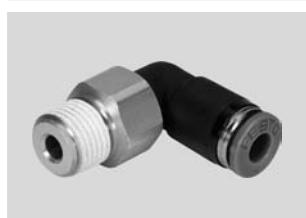
Цанговые штуцеры, вращающиеся на 360°. Шарикоподшипник позволяет штуцеру вращаться с частотой до 500 об/мин. Для применений пневматики в условиях рабочей температуры до 60 °C и давления до 14 бар.
