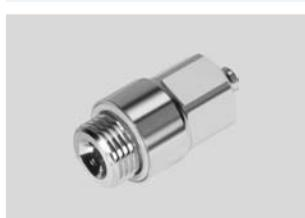
Штуцеры из нержавеющей стали для использования в условиях интенсивной мойки. Наивысший класс стойкости к коррозии (CRC 4). Для применений пневматики с рабочей температурой до 120 °C и давлением до 12 бар.
