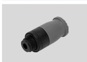
Полимерные штуцеры для простого монтажа одной рукой. Стойкость к гидролизу, соответствие стандартам Управления по санитарному надзору за качеством пищевых продуктов и медикаментов (FDA). Для применений пневматики с рабочей температурой до 60 °C и давлением до 10 бар.
