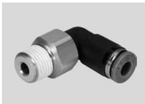
Цанговые штуцеры, вращающиеся на 360°. Шарикоподшипник позволяет штуцеру вращаться с частотой до 500 об/мин. Для применений пневматики в условиях рабочей температуры до 60 °С и давления до 14 бар. Шланги с внешним диаметром 4, 6, 8, 10 и 12 мм и присоединительная резьба M5, R1/8 ... R1/2 и G1/8 ... G1/2.
