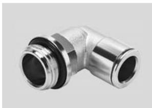
Цанговые штуцеры по привлекательной цене для применения в условиях рабочей температуры до 70 °С и давления до 16 бар. Шланги с внешним диаметром 3, 4, 6, 8, 10, 12 и 14 мм и присоединительная резьба M5, M7 и G1/8 ... G1/2.
