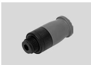
Полимерные штуцеры для простого монтажа одной рукой. Стойкость к гидролизу, соответствие стандартам Управления по санитарному надзору за качеством пищевых продуктов и медикаментов (FDA). Для применений пневматики с рабочей температурой до 60 °С и давлением до 10 бар. Шланги с внешним диаметром 6 мм и присоединительная резьба G1/8.
