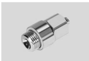
Штуцеры из нержавеющей стали для использования в условиях интенсивной мойки. Наивысший класс стойкости к коррозии (CRC 4). Для применений пневматики с рабочей температурой до 120 °С и давлением до 12 бар. Шланги с внешним диаметром 4, 6, 8 и 10 мм и присоединительная резьба M5 и G1/8 ... G3/8.
