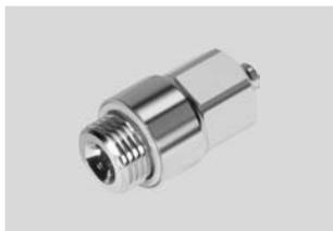
Штуцеры из нержавеющей стали для использования в условиях интенсивной мойки. Наивысший класс стойкости к коррозии (CRC 4). Для применений пневматики с рабочей температурой до 120 °C и давлением до 12 бар. Шланги с внешним диаметром 4, 6, 8 и 10 мм и присоединительная резьба M5 и G1/8 ... G3/8.
