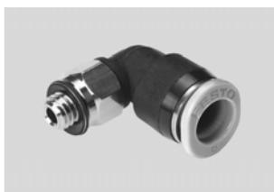
Миниатюрные цанговые штуцеры для максимально плотного монтажа в ограниченном пространстве. Для применений пневматики в условиях рабочей температуры до 60 °C и давления до 10 бар. Шланги с внешним диаметром 3, 4 и 6 мм и присоединительная резьба M3, M5, M7, R $\frac{1}{8}$ .
