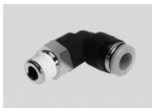
Для основных применений пневматики с рабочей температурой до 60 °C и давлением до 10 бар. Шланги с внешним диаметром 4, 6, 8, 10, 12 и 16 мм и присоединительная резьба M5 и R $\frac{1}{8}$  ... R $\frac{1}{2}$ .
