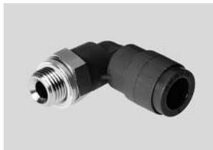
Стойкие к пламени цанговые штуцеры для использования в местах, где присутствует риск появления пламени и искр, например, в системах сварки в автомобильной промышленности и строительстве. Для применений пневматики в условиях рабочей температуры до 60 °C и давления до 10 бар. Шланги с внешним диаметром 4, 6, 8, 10 и 12 мм и присоединительная резьба R $\frac{1}{8}$  ... R $\frac{1}{2}$  и G $\frac{1}{8}$  ... G $\frac{1}{2}$ .
