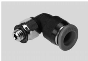
Миниатюрные цанговые штуцеры для максимально плотного монтажа в ограниченном пространстве. Для применений пневматики в условиях рабочей температуры до 80 °C и давления до 14 бар. Шланги с внешним диаметром 2, 3, 4 и 6 мм и присоединительная резьба M3, M5, M6, M7, R $\frac{1}{8}$  и G $\frac{1}{8}$ .
