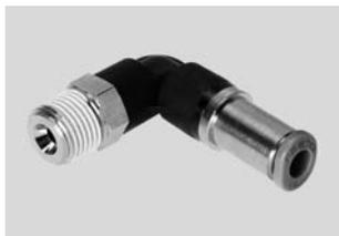
Цанговые штуцеры с перекрытием воздуха при отключении шланга. Для применений пневматики в условиях рабочей температуры до 60 °C и давления до 14 бар. Шланги с внешним диаметром 4, 6, 8, 10 и 12 мм и присоединительная резьба M5, R1/8 ... R1/2 и G1/8 ... G1/2.
