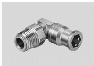
Цанговые штуцеры из нержавеющей стали. Высокая стойкость к коррозии (CR4) и химическая стойкость, одобрены для использования в пищевой и упаковочной промышленности. Для применений пневматики в условиях рабочей температуры до 120 °C и давления до 10 бар. Шланги с внешним диаметром 4, 6, 8, 10, 12 и 16 мм и присоединительная резьба M5 и R $\frac{1}{8}$  ... R $\frac{1}{2}$ .
