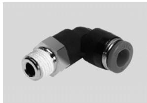
Широкий выбор цанговых штуцеров для применения в условиях рабочей температуры до 80 °C и давления до 14 бар. Шланги с внешним диаметром 4, 6, 8, 10, 12, 16 и 22 мм и присоединительная резьба R $\frac{1}{8}$  ... R $\frac{1}{2}$  и G $\frac{1}{8}$  ... G $\frac{3}{4}$ .
