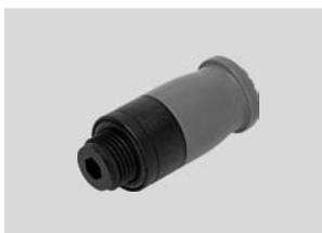
Полимерные штуцеры для простого монтажа одной рукой. Стойкость к гидролизу, соответствие стандартам Управления по санитарному надзору за качеством пищевых продуктов и медикаментов (FDA). Для применений пневматики с рабочей температурой до 60 °С и давлением до 10 бар. Шланги с внешним диаметром 6 мм и присоединительная резьба G1/8.
