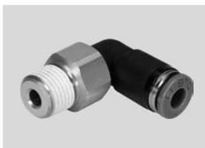
Цанговые штуцеры, вращающиеся на 360°. Шарикоподшипник позволяет штуцеру вращаться с частотой до 500 об/мин. Для применений пневматики в условиях рабочей температуры до 60 °С и давления до 14 бар. Шланги с внешним диаметром 4, 6, 8, 10 и 12 мм и присоединительная резьба M5, R1/8 ... R1/2 и G1/8 ... G1/2.
