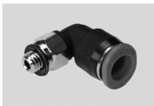
Миниатюрные цанговые штуцеры для максимально плотного монтажа в ограниченном пространстве. Для применений пневматики в условиях рабочей температуры до 80 °С и давления до 14 бар. Шланги с внешним диаметром 2, 3, 4 и 6 мм и присоединительная резьба M3, M5, M6, M7, R $\frac{1}{8}$ и G $\frac{1}{8}$ .
