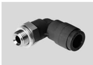
Стойкие к пламени цанговые штуцеры для использования в местах, где присутствует риск появления пламени и искр, например, в системах сварки в автомобильной промышленности и строительстве. Для применений пневматики в условиях рабочей температуры до 60 °С и давления до 10 бар. Шланги с внешним диаметром 4, 6, 8, 10 и 12 мм и присоединительная резьба R $\frac{1}{8}$  ... R $\frac{1}{2}$  и G $\frac{1}{8}$  ... G $\frac{1}{2}$ .
