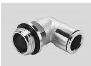
Цанговые штуцеры по привлекательной цене для применения в условиях рабочей температуры до 70 °С и давления до 16 бар. Шланги с внешним диаметром 3, 4, 6, 8, 10, 12 и 14 мм и присоединительная резьба M5, M7 и G1/8 ... G1/2.
