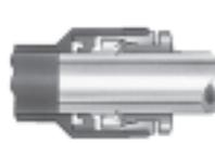
Уплотнительное кольцо из нитриловой резины гарантирует полную герметичность между наружной поверхностью шланга и штуцером. Стандартные шланги могут работать на сжатом воздухе и вакууме.
