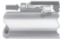
Кольцо из нержавеющей стали надежно удерживает шланг, не повреждая его поверхности. Всякая вибрация и скачки давления полностью погашаются. Шланг можно легко вынуть, нажав на отпускающее голубое кольцо. Для удобства на отпускающем кольце выбит наружный диаметр нужного шланга.
